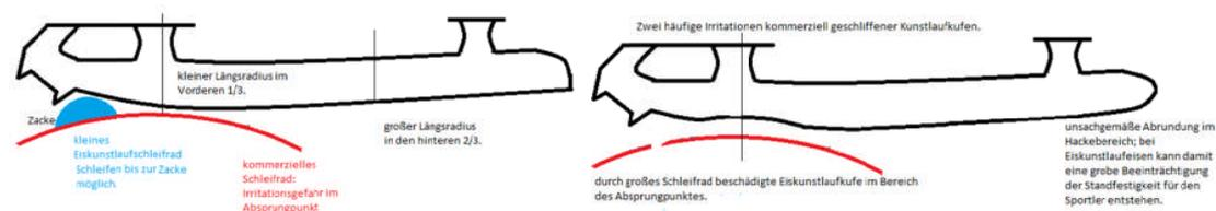
(Infos zur Skizze: links Blau spezielles Eiskunslaufschleifrad (Schliff bis zur Zacke möglich.) Rechts Schliff mit kommerziellem Schleifrad samt Sichtbarmachung der Irritation im Absprungbereich. )
